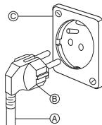
В целях вашей личной безопасности машина должна быть заземлена. Стиральная машина имеет шнур питания (A) с заземляющей вилкой (B). Для снижения риска поражения электрическим током вилку нужно вставлять в подходящую стенную розетку с заземлением (C). Если розетки с заземлением нет, пользователь обязан обратиться к квалифицированному электрику для установки стенной розетки с заземлением.
