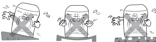
② Скорректируйте горизонтальность машины с помощью регулируемых ножек.
