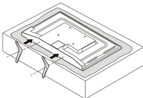
Выберите ровную плоскую горизонтальную поверхность, накройте ее мягкой тканью и разместите на ней корпус телевизора экраном вниз. Присоедините стойки к задней части корпуса телевизора таким образом, чтобы отверстия в стойках и в корпусе совпадали. Зафиксируйте стойки с помощью входящих в комплект винтов.
