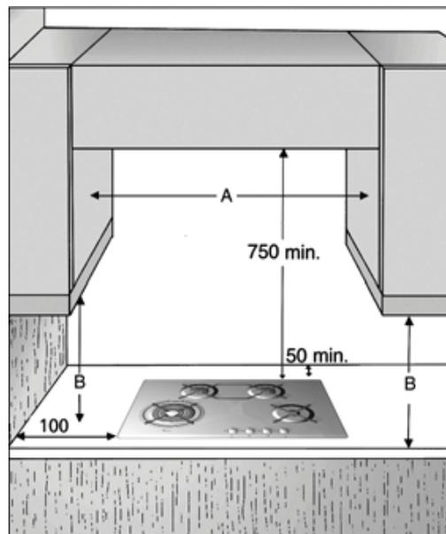
**ПРИМЕЧАНИЕ:** Если расстояние А между настенными шкафчиками составляет от 600 мм до 730 мм, то высота В должна быть не менее 530 мм. Если расстояние "А" между корпусами настенной мебели больше ширины варочной панели, то высота "В" должна быть не менее 400 мм. В случае установки над варочной панелью вытяжки необходимо соблюдать размеры, указанные в руководстве по эксплуатации вытяжки.
