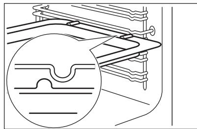
Одновременная установка решетки и глубокого противня:
