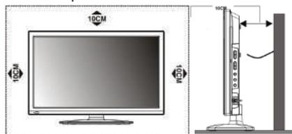
Достаньте телевизор из упаковочной коробки и поставьте его на надежную плоскую поверхность. Вам потребуется закрепить основание (или ножки) телевизора (если оно не закреплено), если вы хотите поставить его, или снять основание (или ножки), чтобы закрепить телевизор на стену.
