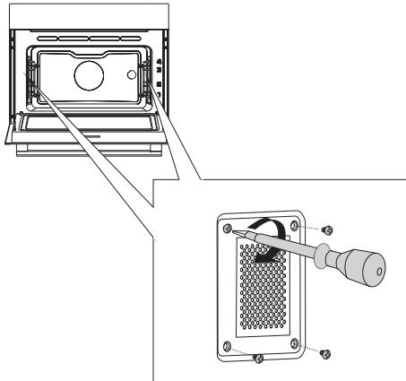
**1** Открутите четыре винта на крышке. Снимите крышку и стекло.
