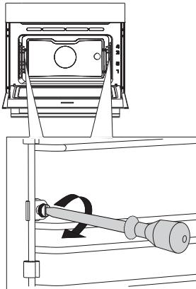
**1** Открутите винты с помощью отвертки.
