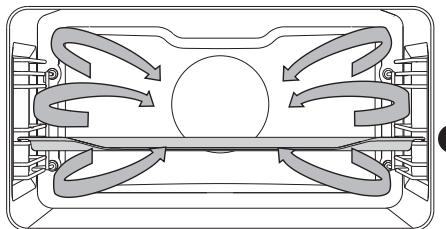
Одновременно работают нагревательный элемент вокруг вентилятора и вентилятор. Вентилятор создает постоянную циркуляцию горячего воздуха вокруг мяса или выпечки.
