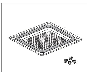
На крышке имеется уплотнитель, который нельзя снимать и который не должен отставать от крышки. Уплотнитель должен плотно прилегать к стенке духовки.
