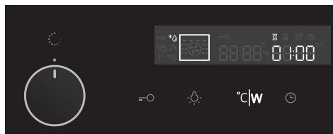
**1** Установите переключатель РЕЖИМА НАГРЕВА в положение «Размораживание». На дисплее начнет мигать символ режима нагрева и обозначение программы A1 (можно выбрать одну из пяти программ – см. таблицу далее).
