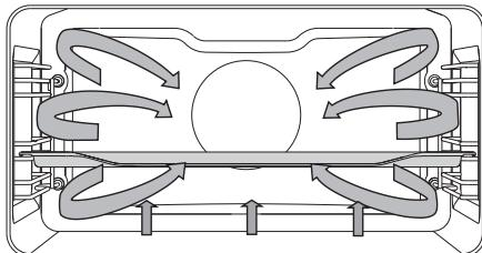
Одновременно работают нижний нагревательный элемент, нагревательный элемент вокруг вентилятора и вентилятор.
