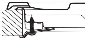
Монтаж крюка для опорных брусков  $H=40\text{mm}$
