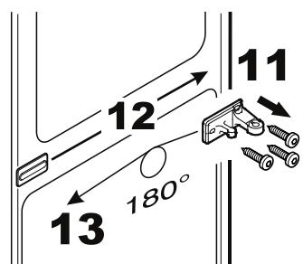
12. Переставьте защитную крышку на противоположную сторону.
