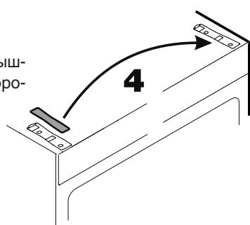
4. Переставьте защитную крышку на противоположную сторону.
