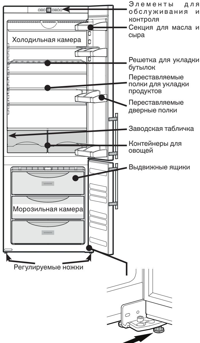
Выворачивайте регулируемую ножку на опорном кронштейне до тех пор, пока она не будет опираться на пол, затем крутите далее по углом 90°.
