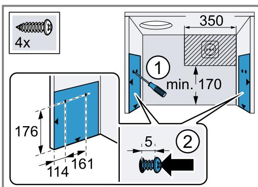
8. Вверните 4 прилагаемых винта для крепежных уголков на расстоянии до 5 мм.
