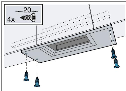
3. С помощью пристеночного бортика отрегулируйте расстояние между прибором и стеной.
