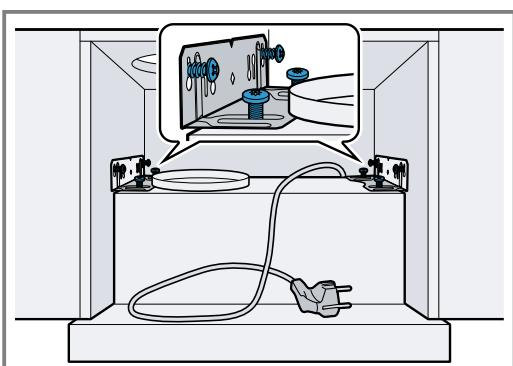
2. Ширина прибора 90 см: полностью вытяните выдвижную вытяжку на себя. Прикрепите прибор дополнительно к боковым навесным шкафам с помощью 2 винтов слева и справа снизу.
