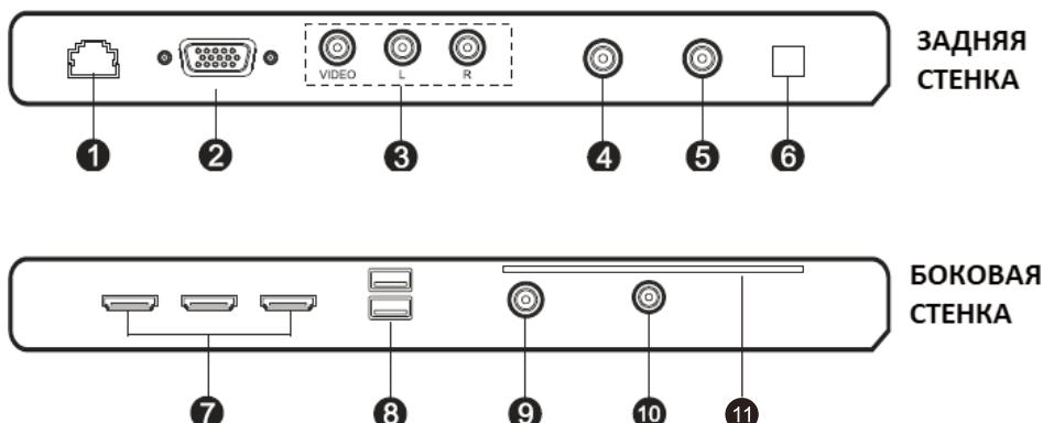
1. **RJ45** – разъем для подключения к интернет-сети
