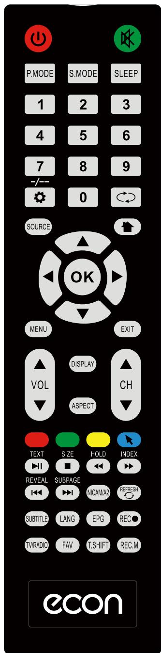
**VOL ▲/VOL ▼** Кнопки регулировки громкости.
