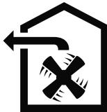
Воздух нельзя отводить в дымоход, используемый для вывода отработавших газов приборов, работающих на газе или других видах топлива (это не относится к устройствам с циркуляцией воздуха).
