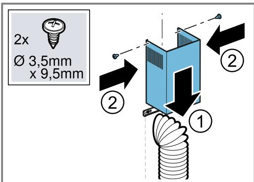
Для эксплуатации вытяжки в режиме отвода воздуха установите обшивку вытяжной трубы прорезями вниз.
