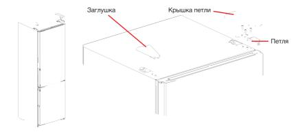
Снимите среднюю петлю, винты и заглушки. Снимите дверь морозильного отделения.
